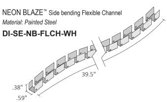
SIDE BENDING STRIP LIGHT SPECIFICATION SHEET
